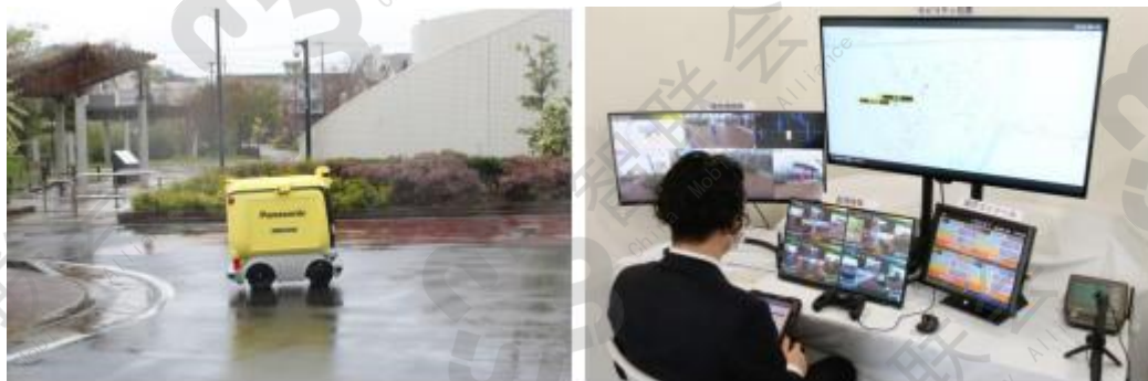
图 7 松下无人配送车及远程监控、操作系统（1 对 4）
