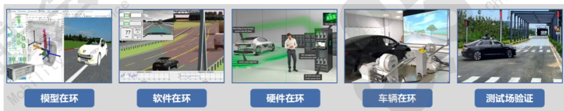
图 2 自动驾驶仿真在环测试流程
