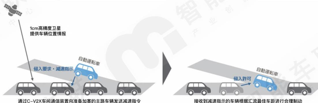
图 13 软银 x SUBARU 汽车高速公路加塞汇流实验示意图
