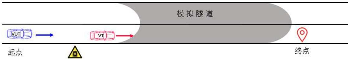
图 D. 32 隧道内跟车场景示意图
