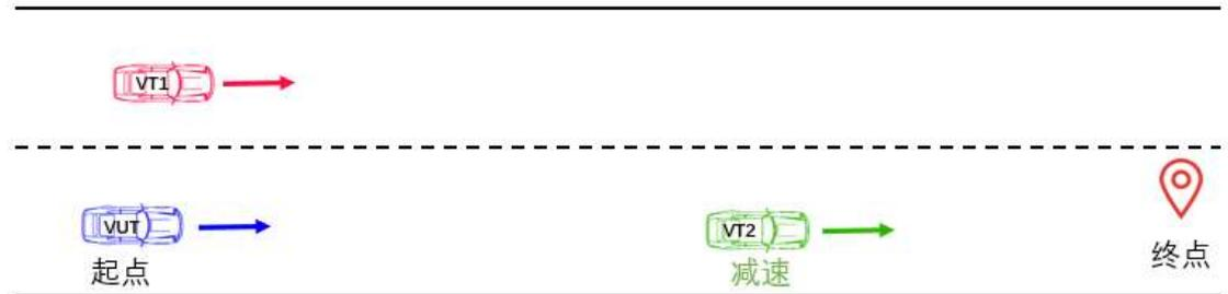
图 D.16 前方车辆急刹场景示意图
