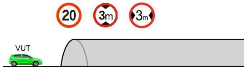
图 B.18 隧道限速/限高/限宽提醒场景示意图
