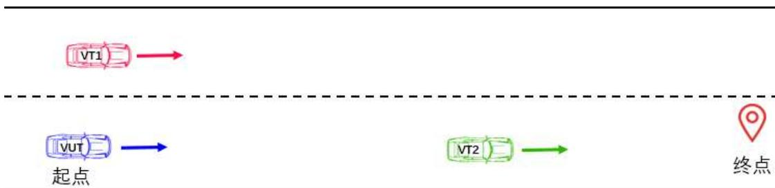
图 E.6 前方车辆急刹场景示意图
