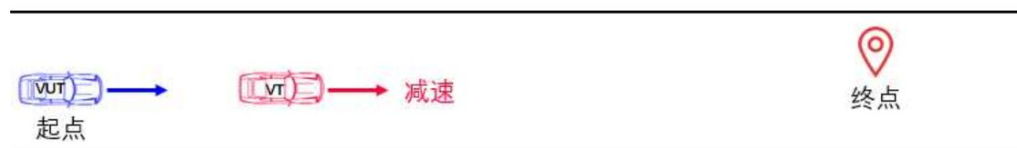
图 A.15 自动紧急避让机动车场景示意图
